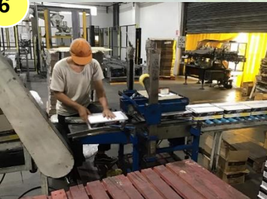
การปิดผนึกกล่องและปั๊มวันเดือนปีที่ผลิตและหมดอายุ
